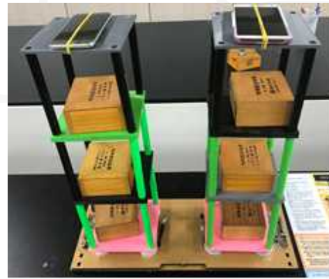
[그림 42] 가속도를 측정하기 전 실험 장치 모습
