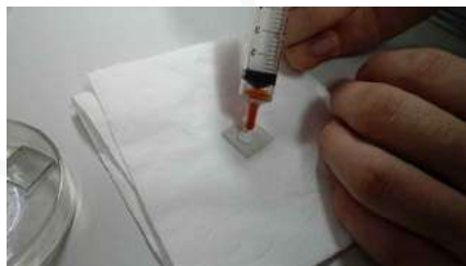
<아이오딘 전해질을 뿌리는 모습> <백금증착된 FTO로 덮는 모습>
