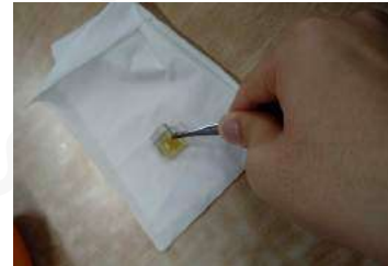
<아이오딘 전해질을 뿌리는 모습> <백금증착된 FTO로 덮는 모습>
