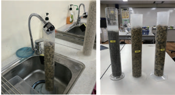
[그림 18. 공극률 측정 과정]
